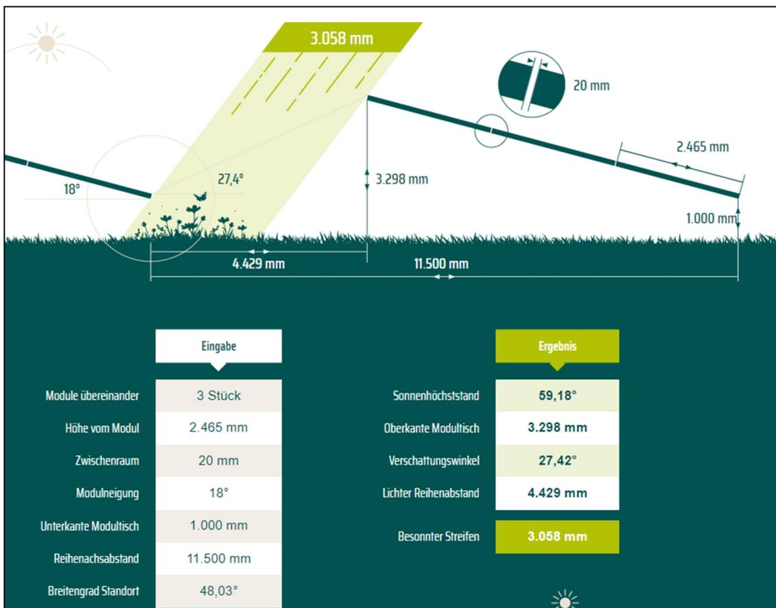
Abbildung 2: Eingangsdaten für die Anlagenvariante 1 (h1) /10/
