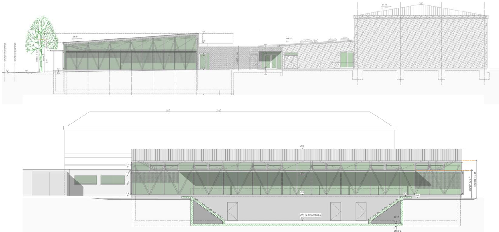
Erweiterung der bestehenden Anlage der beiden Grundschulen. Die Anlage ist in das Gelände eingebettet. Konstruktion über Gelände als Holztragwerk mit Verkleidungen und Glaselementen. Flachdach mit PV-Anlage zur Eigenversorgung.
